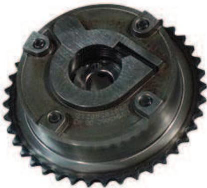
Le déphaseur variable d'arbre à cames est commandé par la pression de l'huile moteur qui est distribuée par le biais d'une électrovanne de distribution variable.
