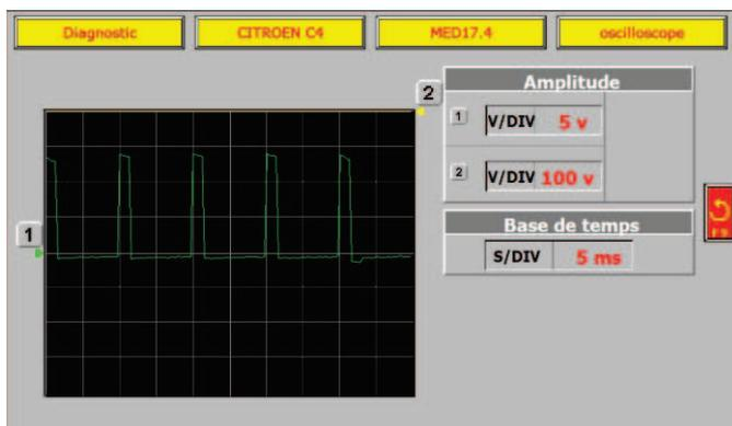
Mesuré aux bornes de l'électrovanne au ralenti
