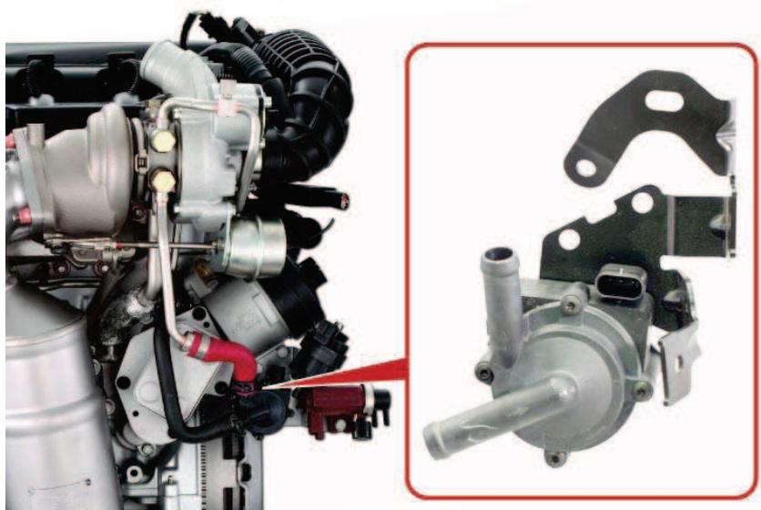
Elle permet de refroidir le turbocompresseur moteur tournant (suivant conditions), et à l'arrêt moteur (phase de Power Latch) pour limiter les contraintes thermiques.
