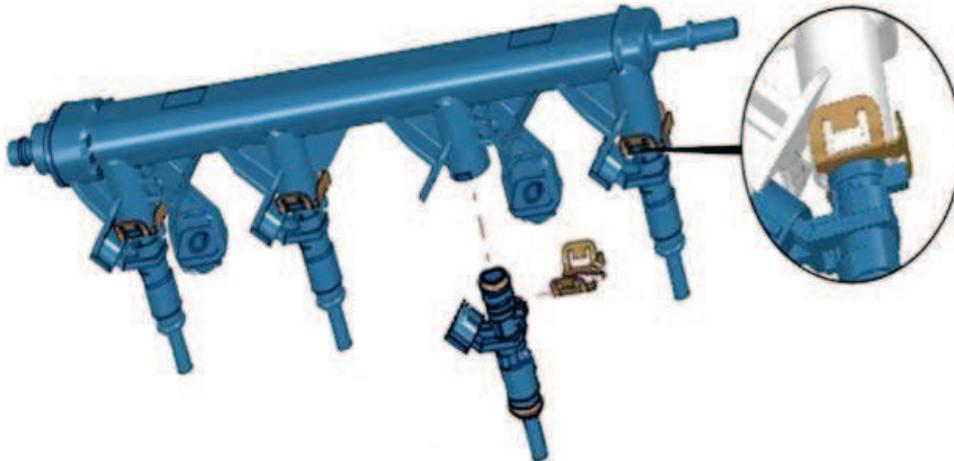
Les injecteurs pulvérisent le carburant en amont du siège de soupape d'admission. Ils sont commandés par le CMM dans l'ordre d'injection (1 - 3 - 4 - 2), pendant la phase d'admission.
